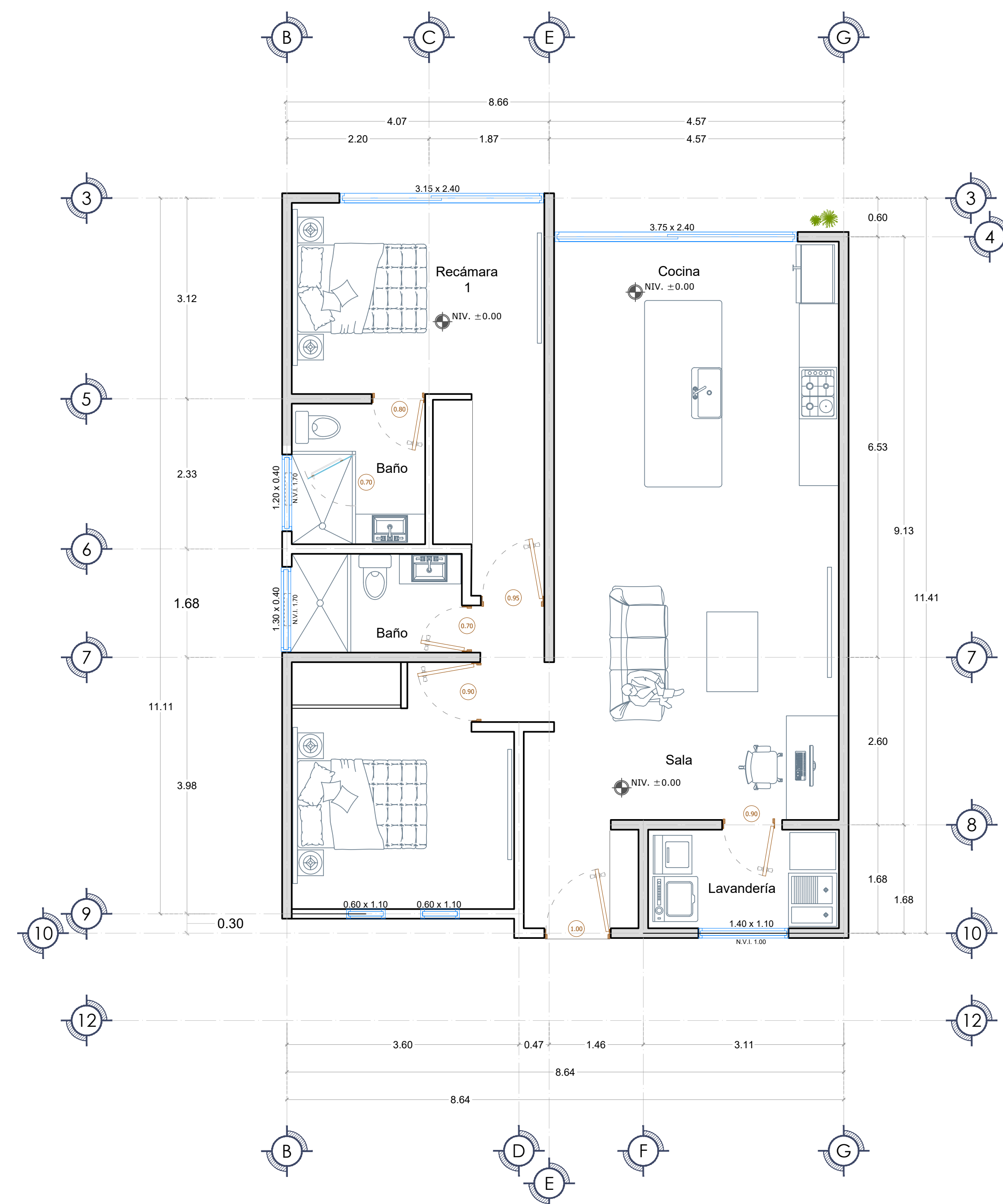
Planta Arquitectónica Esc. 1:75 Área: 98.00 m 2
