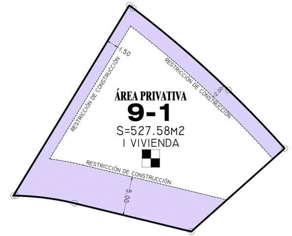
EJEMPLO DE RESTRICCIONES DE CONSTRUCCIÓN
