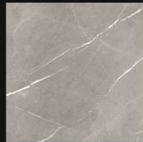
2. PORCELANATO MODELO NEW FOREST MIX, EN MEDIDA DE 15 x 50 CM. DE ESPESOR, JUNTAS A HUESO, SOBRE LOSA DE ENTREPISO Y/O FIRME DE CONCRETO, ADHERIDO MEDIANTE PEGAZULEJO, DESPIECE SEGÚN DISEÑO.
