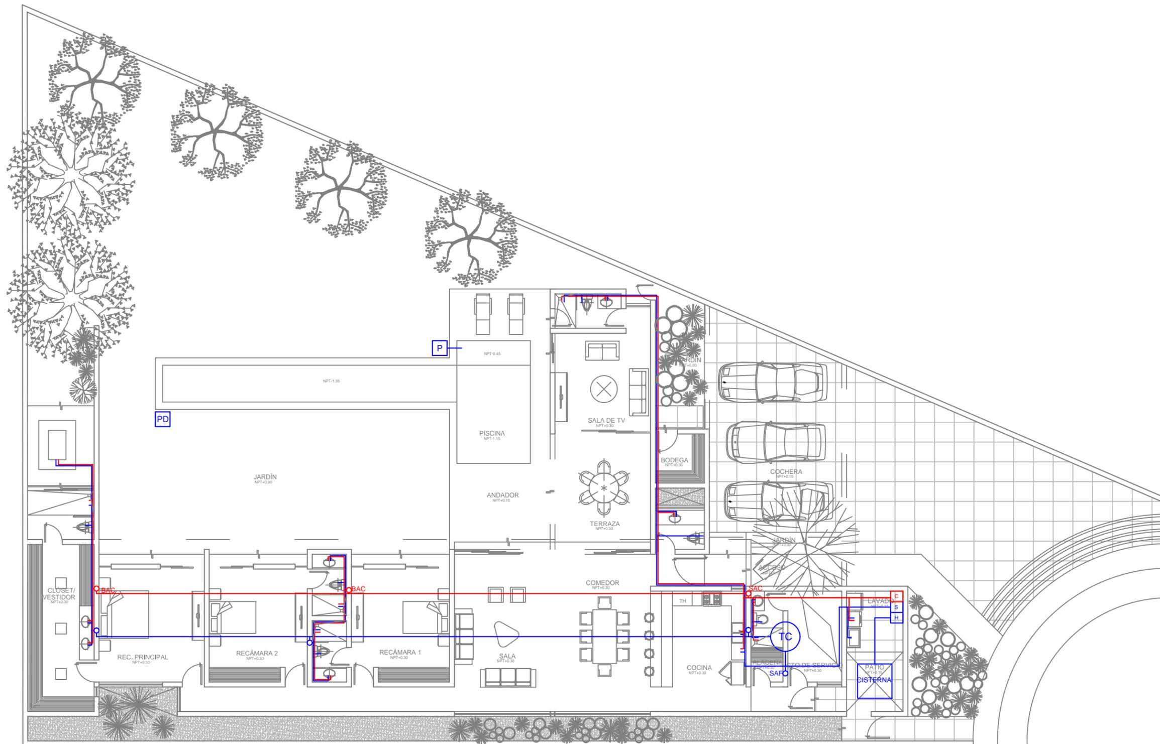
PLANTA DE INSTALACIÓN HIDRÁULICA
