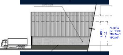
FIRME DE CONCRETO ARMADO CON PERALTE DE 15CM, RESISTENCIA DE 8 TON/M2.
