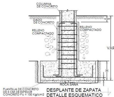
10.1.4 Zapata aislada de concreto hecho en obra F'c=250 kg/cm<sup>2</sup>, armada con varilla del No. 4 a cada 0.2 m. en ambos sentidos y dado armado con 4 vars.# 4, y estribos # 3 @ 0.2 m.
