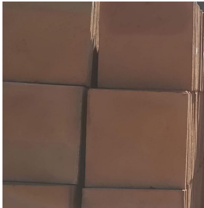
Piso en exterior: Ladrillo (cuadrado rojo 30)
