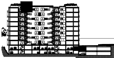
Corte del Edificio
