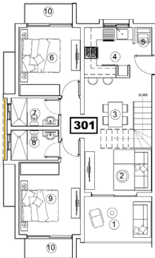
PLANTA ARQUITECTONICA TERCER NIVEL 2 DORMITORIOS
