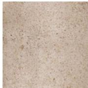
Placas de concreto blanco de 6cm de espesor, desbastado y pulido.
